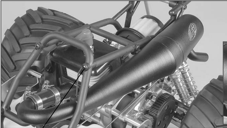
Linsen-Blechschrabe/ Pan-head sheet met. screw 4,2x32
